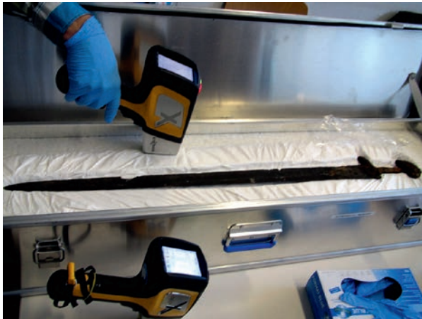
Abb. 1 Portable Röntgenfluoreszenzmessungen (pRFA) am Schwert, hier vor der Restaurierung (R. Lehmann).
