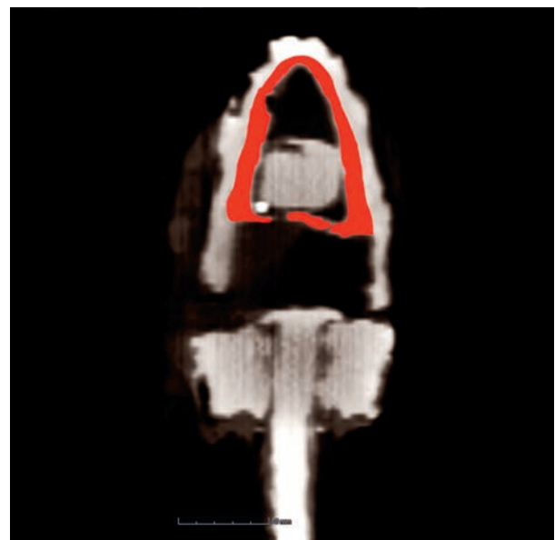
Abb. 16 Blech unter dem Bügel (rot markiert) und die Innenwandung der Kappe.
